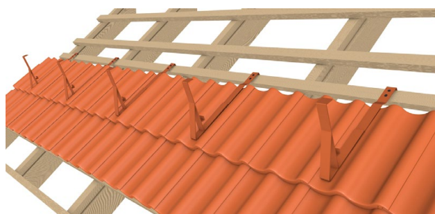
Přídavná lať 40/60, 3x vrut \varnothing 5 mm
