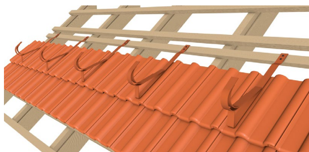
Přídavná lať 40/60, 3x vrut \varnothing 5 mm
